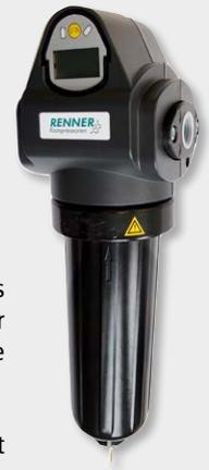
RENNER Druckluftfilter sind zum Abscheiden von Öl- und Wasseraerosolen sowie zur Entfernung von festen Verunreinigungen aus der Druckluft vorgesehen. Selbst Stäube werden an der Oberfläche und in der Tiefe des Filtermaterials sicher zurückgehalten. Unter Ausnutzung verschiedener Filtrationsmechanismen – wie Abscheidung durch direktes Abfangen, Trägheitsaufprall und Braunsche Molekularbewegung – erzielt man eine nahezu hundertprozentige Abscheideleistung.
